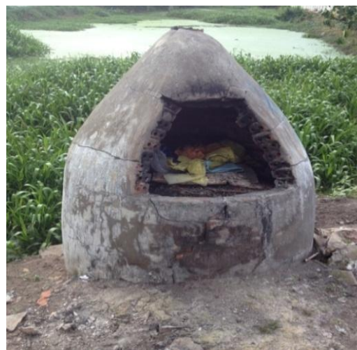
Hình 2.14. Lò đốt chất thải tại một số cơ sở chăn nuôi tập trung
